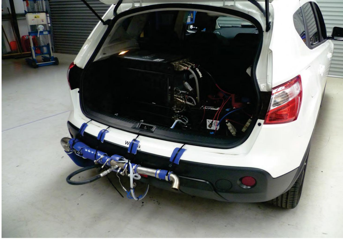
Şekil 5.4. Her test aracına kurulan portatif emisyon ölçüm sistemi (PEMS) (Offices ve diğerleri, 2016)
