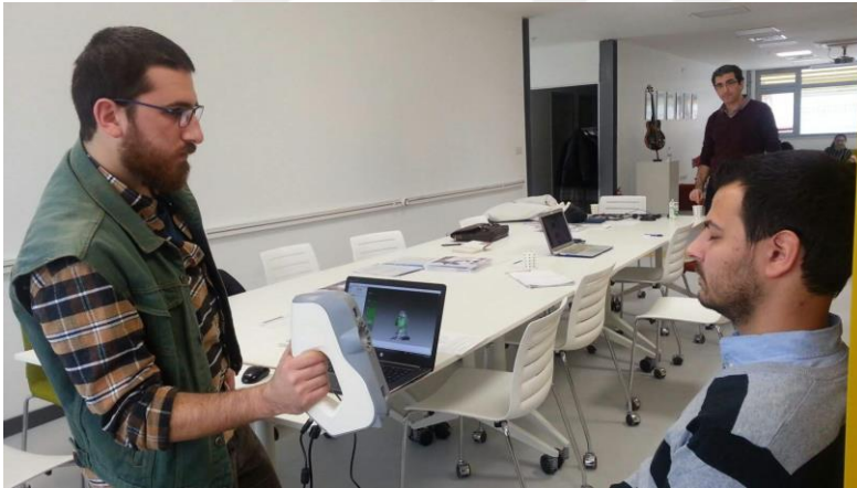
Resim 3.7. Artec Eva cihazı ile yapılan 3 boyutlu tarama işlemi
