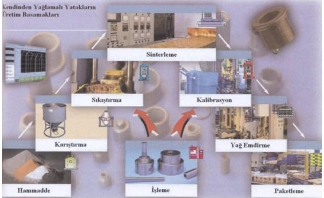
Şekil 4.2. Kendinden yağlamalı yatakların üretimi [28]
