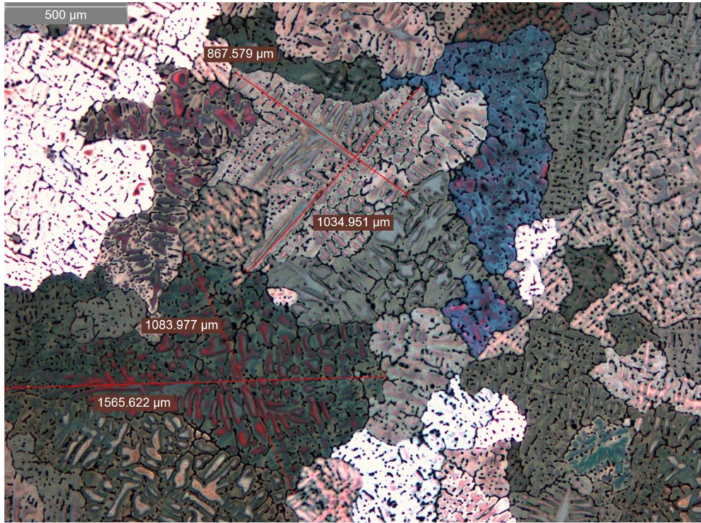
Resim 4.1. Tane inceltme yapılmamış A206 alaşımının tane yapısı
