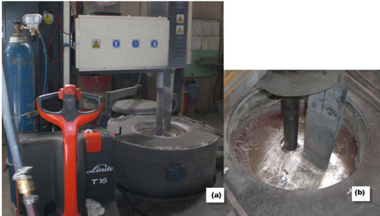
Resim 3.2. Döner sistemli gaz alma ve cüruf giderme cihazı a) genel görünüm ve b) yakın görünüm
