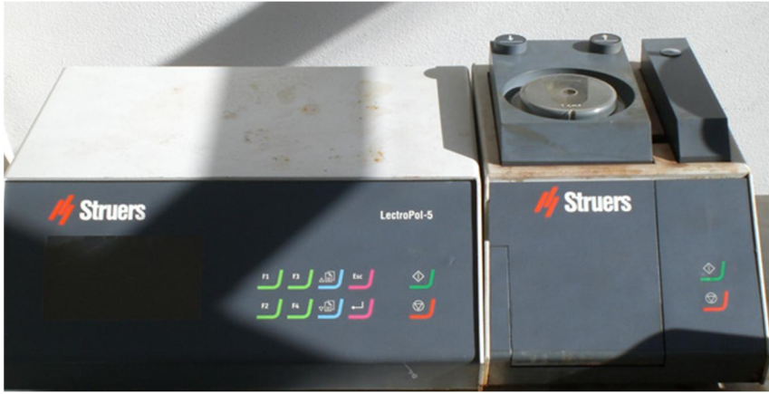
Resim 3.3. Elektrolitik parlatma cihazı
