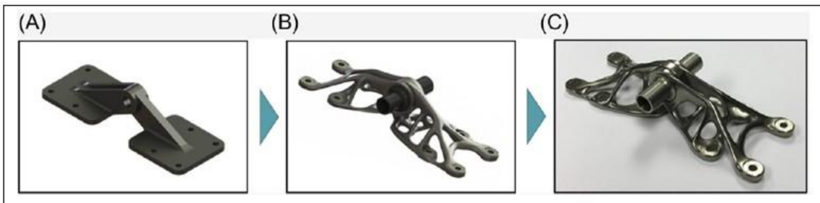
Resim 2.6. Eklemeli imalat için topolojik optimizasyonu yapılmış mafsal parçası. (A) ilk tasarım, (B) topolojik optimizasyona göre yeni tasarım, (C) eklemeli imalat ile üretilmiş mafsal [19]
