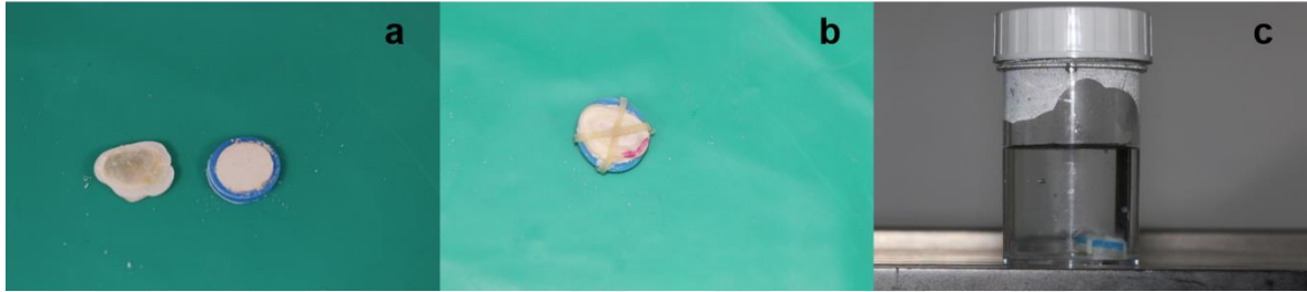
Resim 3.7. (a) Dentin kesiti ve PVC halka içerisinde hazırlanan deney materyalleri, (b) Dentin kesiti ve deney materyalinin ortodontik lastik kullanılarak sıkı temasının sağlanması, (c) Dentin kesiti ve materyal diskinin 15 ml DPBS içinde yerleştirilmesi
