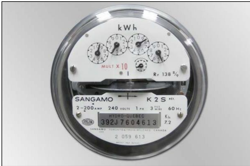
Şekil 3.1. Elektromekanik elektrik sayacı (Fleming, 1914)
