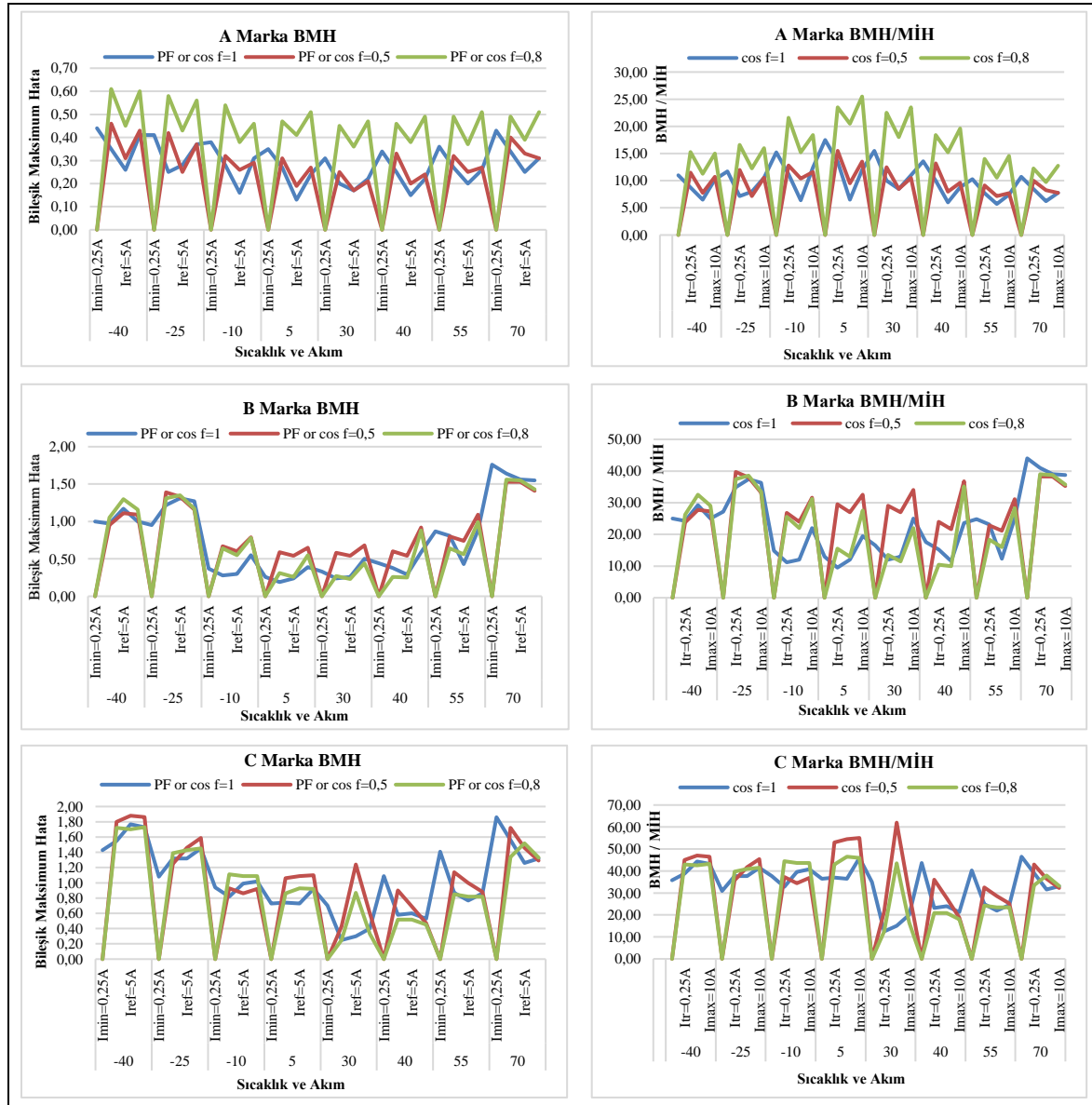
Şekil 4.3. A, B ve C marka elektrik sayacının farklı sıcaklık ve akım değerlerinde tüm güç faktörlerinde göre gerçek BMH hatası ve BMH/MİH oranı (Tasci ve Düzkaya, 2023)
