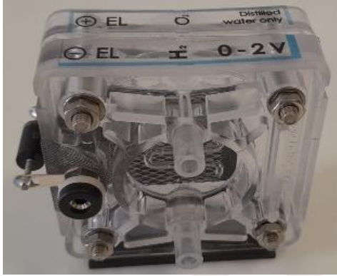
Şekil 3.2. PEM elektrolizör hücresi
