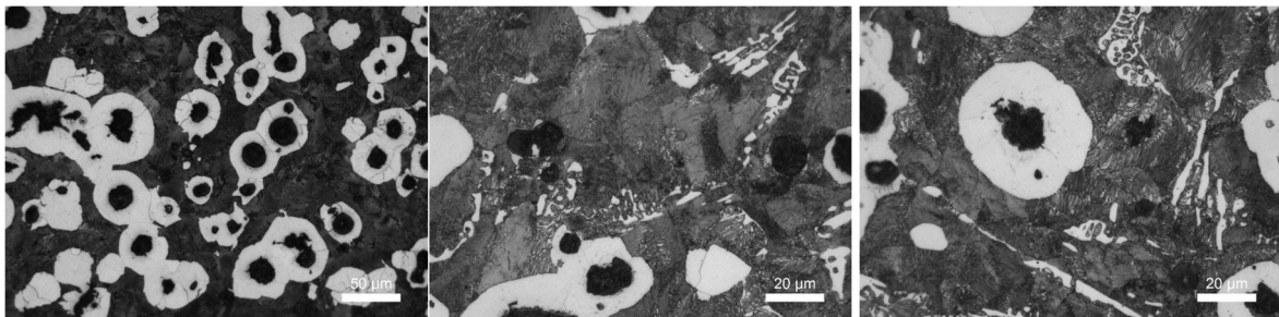
Şekil 2. Kum kalıba döküm ve 2 farklı sıcaklıkta (300 ve 550 °C) ön ısıtma uygulanmış döküm sonucunda elde edilen malzeme mikro yapıları
