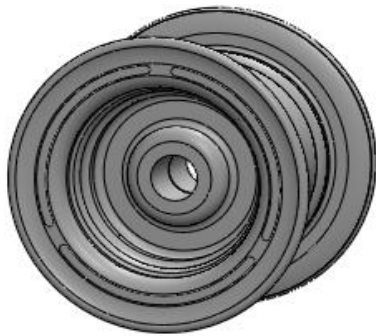
Şekil 4.1. Burun iniş takımı jantı
