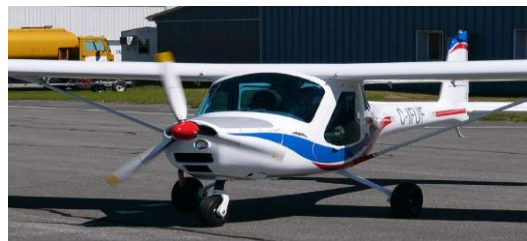
b. Sabit İniş Takımına sahip 3Xtrim 3x55 Trener uçağı
