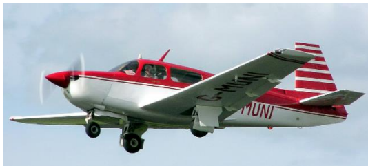
a. Geri Çekilebilir İniş takımı sistemine sahip Mooney M20 uçağı
