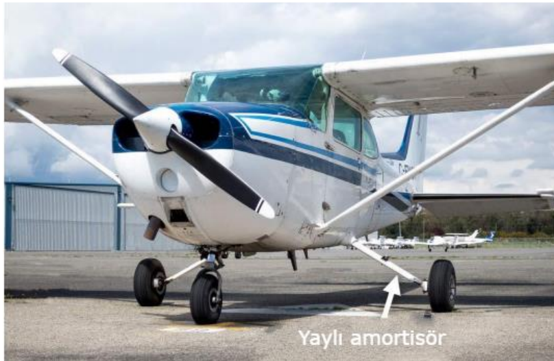
Şekil 3.3. Katı yaylı amortisör tipi [6]
