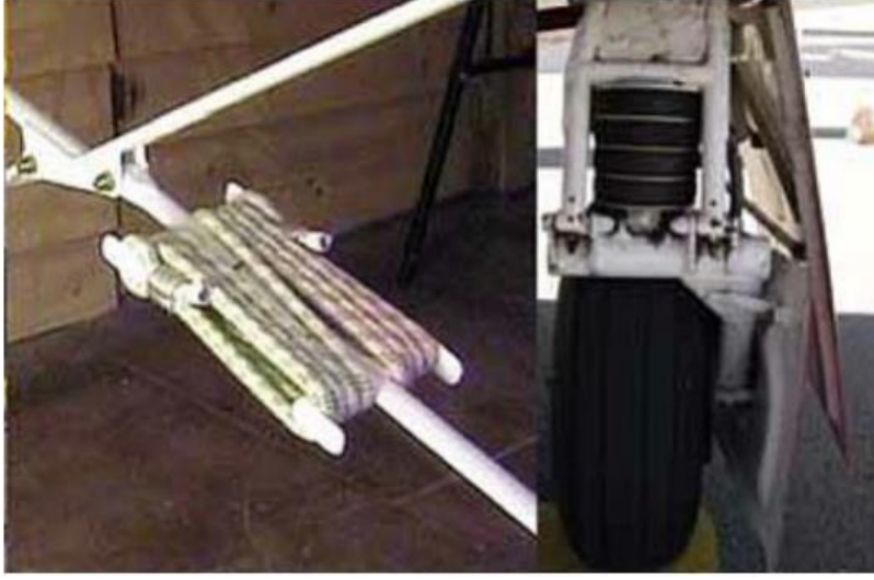
Şekil 3.4. Halat tipi amortisör [7]
