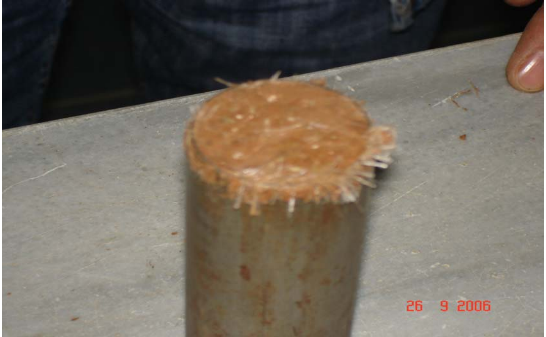
Resim 3.10. Numune alıcı içerisine alınmış KAK numunesinin görünümü [7]
