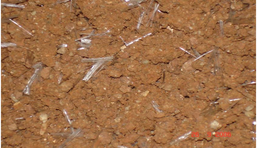
Resim 3.4. Kil içerisinde polifiber dağılımı [7]
