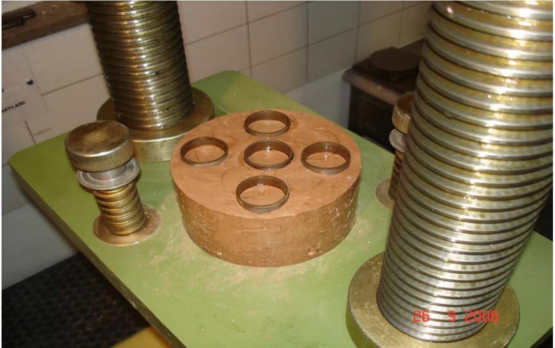
Resim 3.8. KAK numunesinin alıcılar içerisine yerleştirilmesi [7]
