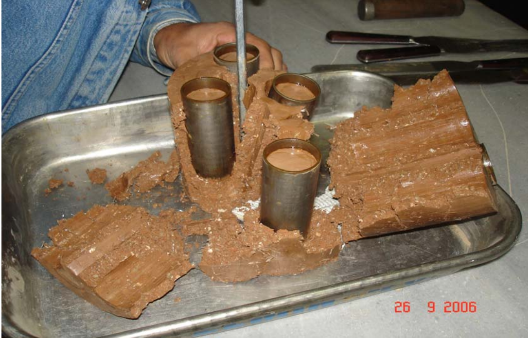
Resim 3.9. Numune tüplerinin çıkartılması [7]
