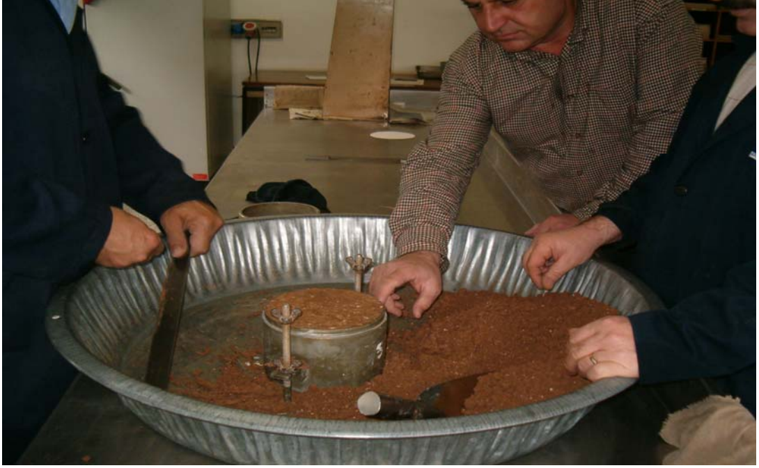
Resim 3.7. CBR kalıbında sıkıştırılmış KAK numunesi [7]
