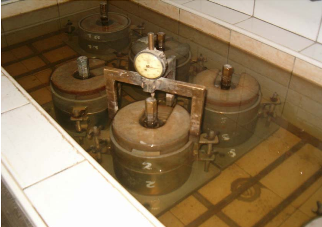
Resim 3.17. KAK numunesinin yaş CBR'a yatırılması [7]
