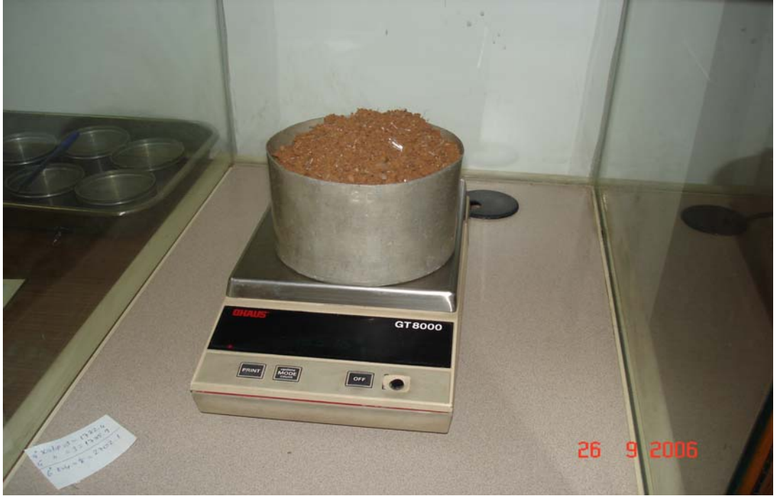
Resim 3.5. KAK numunesinin OSM ve MKBA tespiti için yapılan tartımlar [7]
