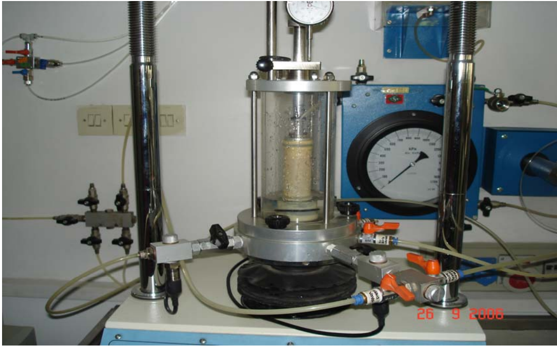
Resim 3.13. KAK numunesinin üç eksenli deney aletine yerleştirilmesi [7]
