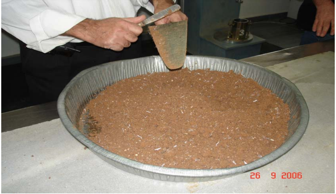
Resim 3.3. Polifiberin kil içerisinde karıştırılması [7]
