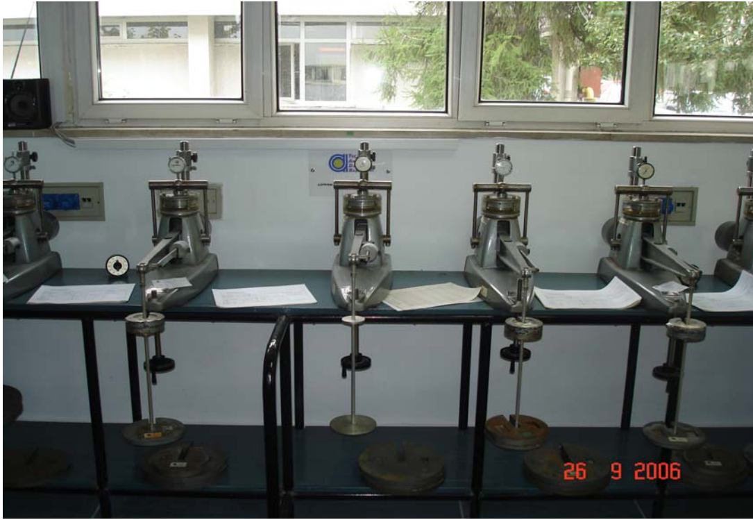
Resim 3.18. KAK numunelerinin konsolidasyon aletinde yüklenmesi [7]
