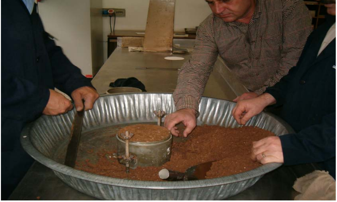
Resim 3.11. Kalıbın ilave yakasının ıkartılıp elik cetvelle dztilmesi [7]
