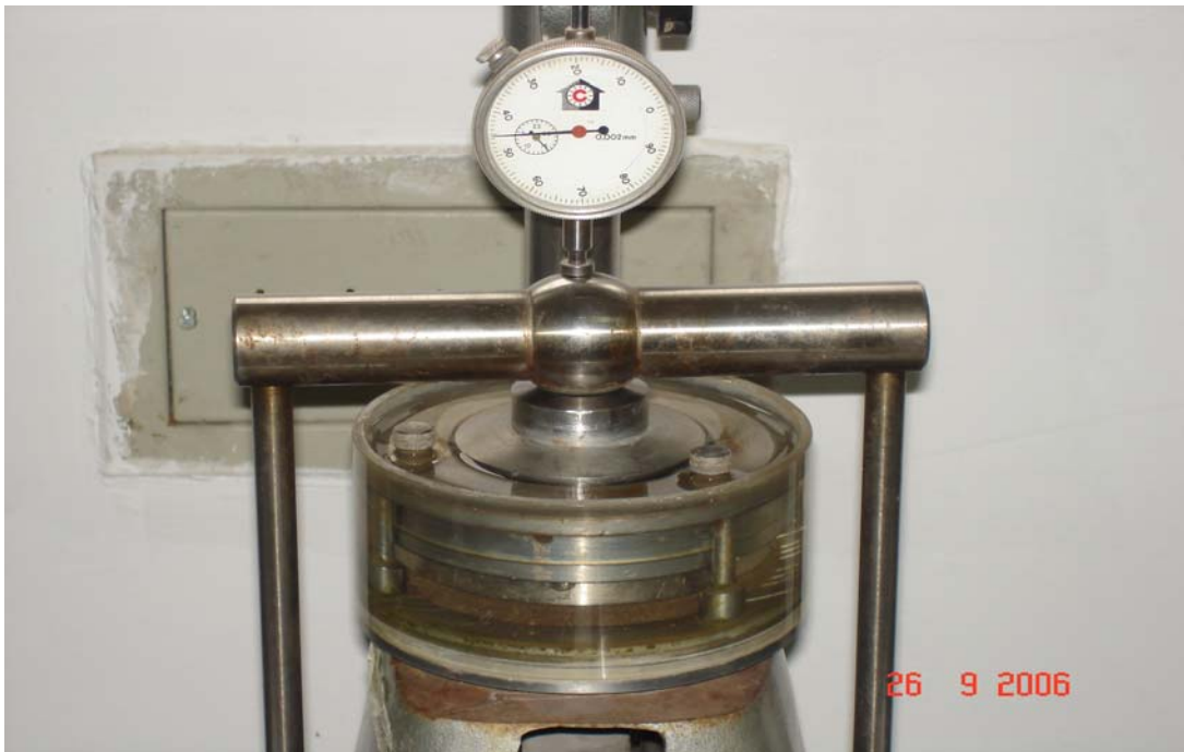
Resim 3.19. KAK numunesinin yük kademelerinde okumalarının alınması [7]
