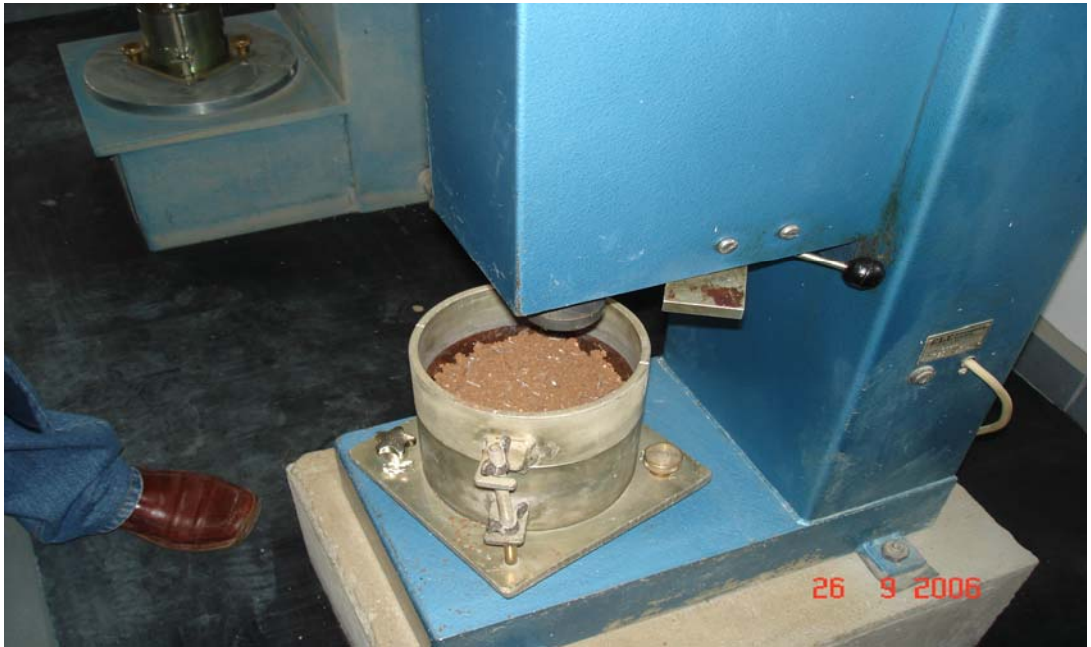
Resim 3.6. Optimum su muhtevasında KAK numunesinin sıkıştırılması [7]
