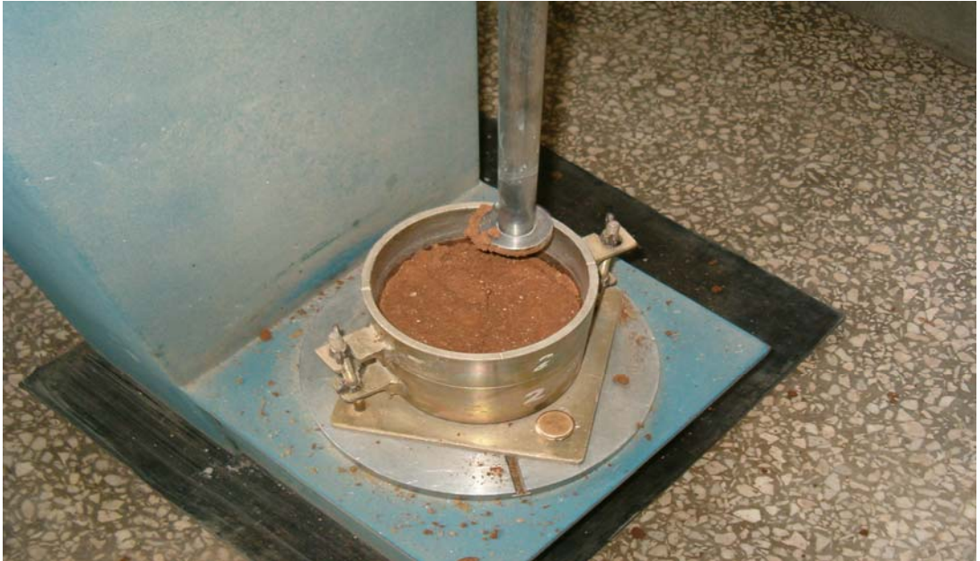
Resim 3.12. KAK numunesinin proctor aletinde sıkıřtırılması [7]
