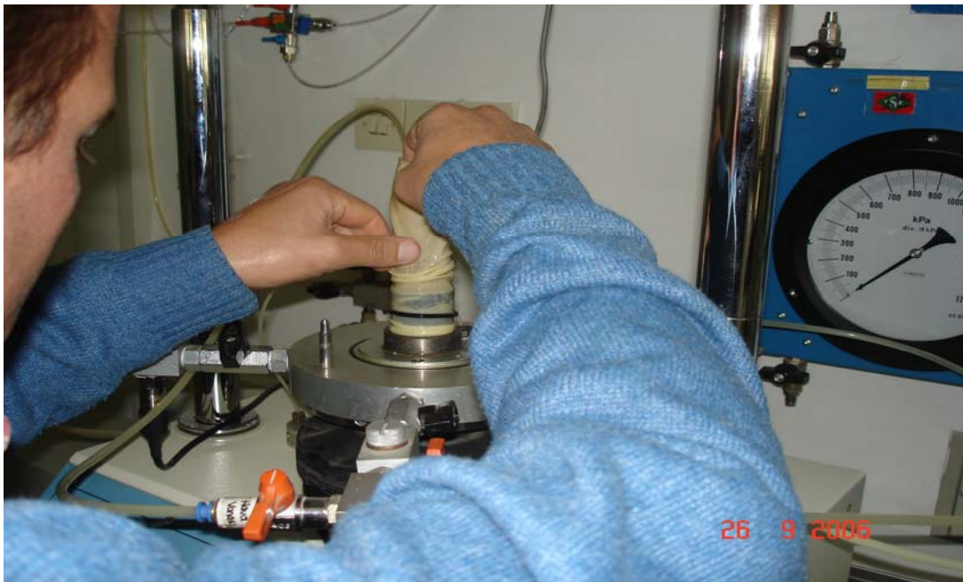
Resim 3.14. Kırılan KAK numunesinin üç eksenli deney aletinden çıkartılması [7]
