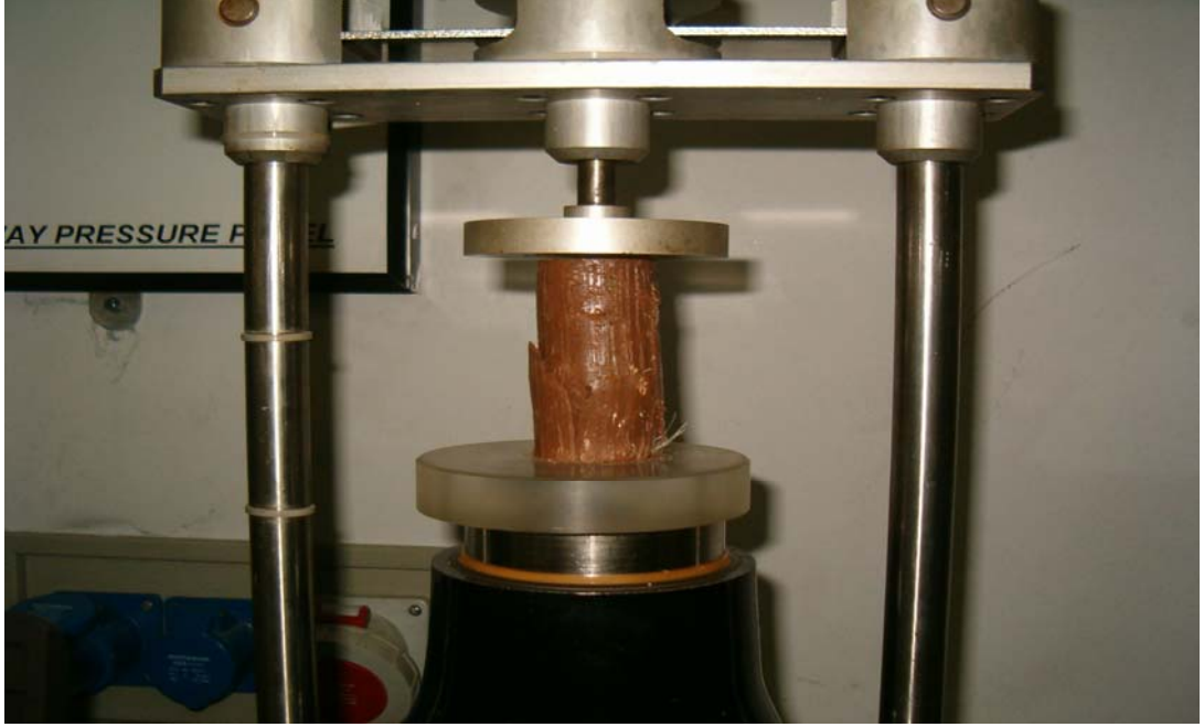
Resim 3.15. Serbest basınç cihazında KAK numunesinin kırılma anı [7]
