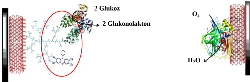
Şekil 2.23. Biyoanot ve biyokatot yüzeylerinin hazırlanmasının şematik görüntüsü
