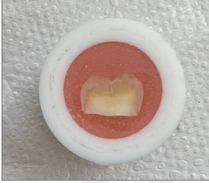
Resim 3.2. Akrilik içerisine gömülmüş diş numunesi
