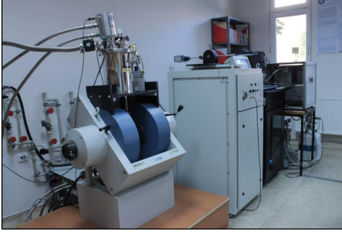
Resim 2.2. Lake Shore 7700 Serisi Yüksek Empedans Hall Etkisi Sistemi
