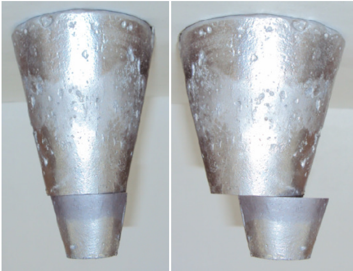
Resim 3.2. Tane inceltme deney numuneleri
