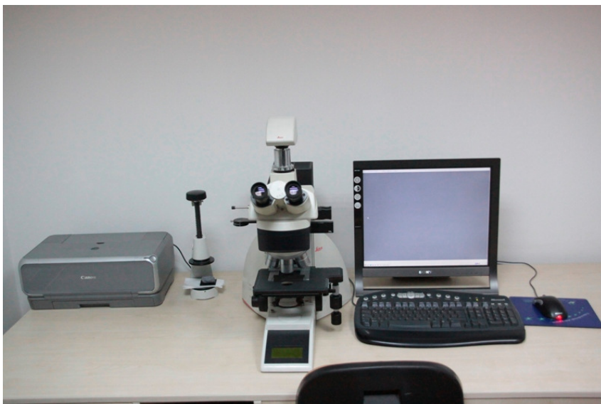
Resim 3.4. Mikroyapıların görüntülenmesinde kullanılan optik mikroskop
