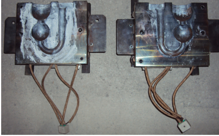
Resim 3.6. Rezistans ısıtıcılı kokil kalıp
