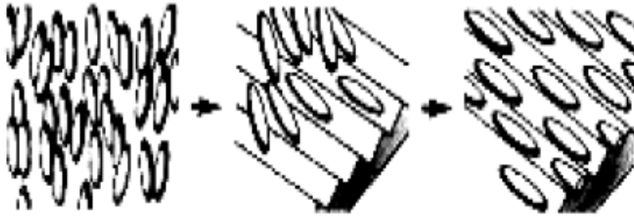
Şekil 2.20. Sıvı kristal moleküllerin oluklu yüzey boyunca dizilimi
