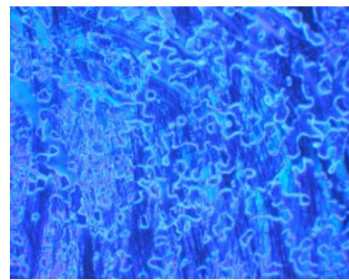
Resim 9.1. 1CA katkılı E7 sıvı kristaline ait farklı sıcaklıklardaki tekstürler
