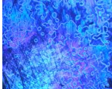
Resim 6.2. Nematik-izotropik faz geçişi sırasında E7/1CA/SWCNT karışımına ait tekstürler
