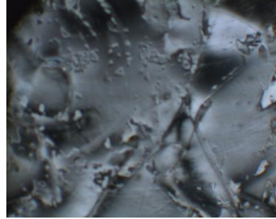
Resim 4.2. Nematik fazın kararlılığını koruduğu sıcaklık aralığında, soğutma ve ısıtma işlemleri sırasında E7 sıvı kristaline ait tekstürler
