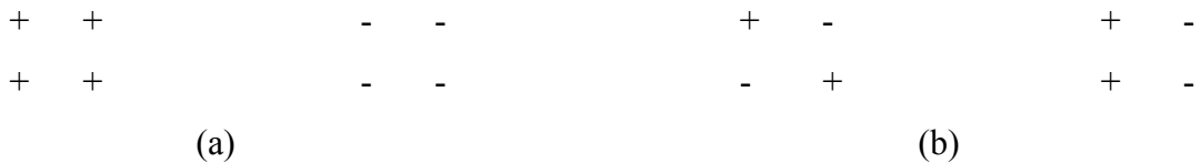
Şekil 2.3. Spin 1/2 Ising model için taban durumlar a) Ferromanyetik taban durumlar b) Antiferromanyetik taban durumlar
