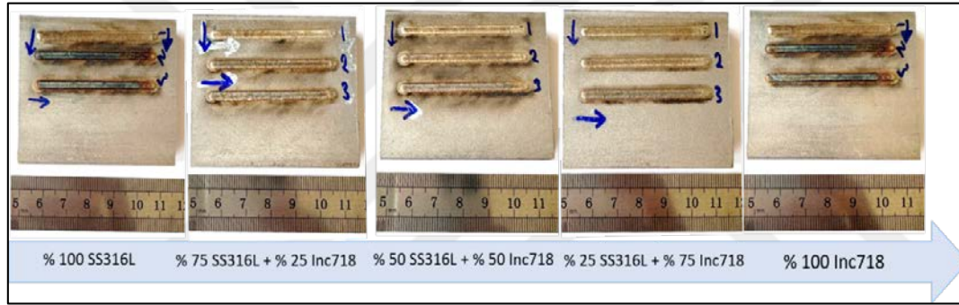
Resim 3.3. SS316L-IN718 alaşımlarından farklı kompozisyon oranlarıyla üretilmiş tek dikişli numunelerin üstten görünümü
