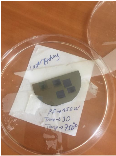
Resim 5.3. Doğrusal olmayan lazer litografi (NLL) tekniği ile desenlendirilmiş p-Si
