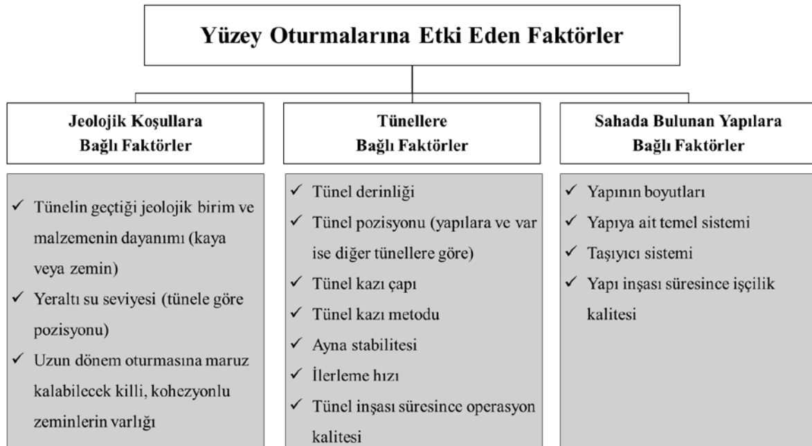
Şekil 4.3. Yüzey oturmalarına etki eden genel faktörler [35]
