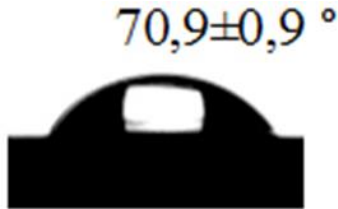
Şekil 5.8. Si-ED yüzeyine ait su değme açısı sonucu ve oluşan su damlacığının görüntüsü
