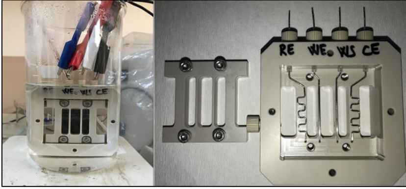
Şekil 4.11. 4 prob ile proton iletkenliği ölçümünün deneysel görüntüleri
