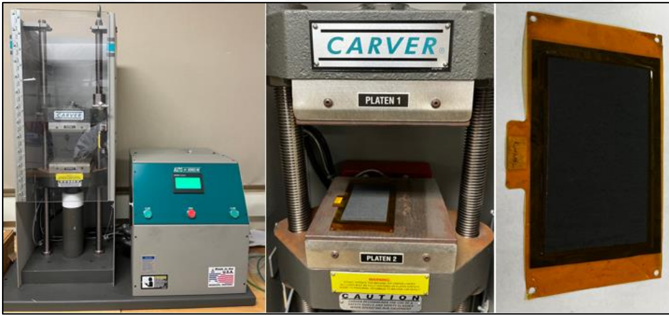
Şekil 4.18. MEA sıcak pres süreci
