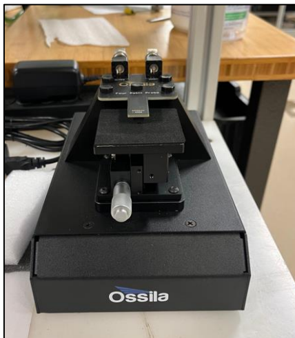
Şekil 4.13. Osilla 4 prop elektrik iletkenliği ölçüm cihazı
