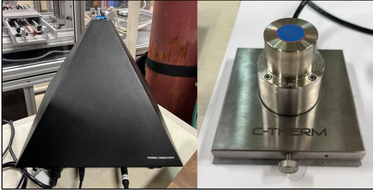
Şekil 4.14. C-Therm termal iletkenlik ölçüm cihazı
