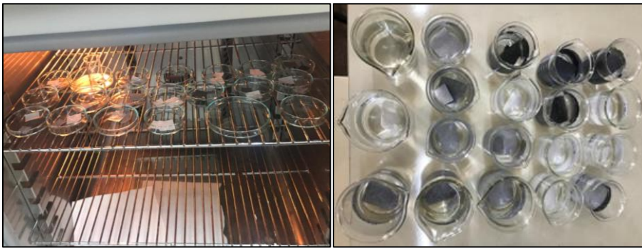
Şekil 4.9. Membran numunelerinin etüv ortamında kurutulması ve deiyonize suda bekletilmesi
