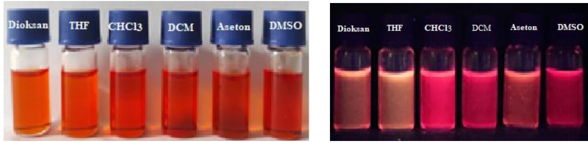
Resim 6.1. 5 Numaralı (20 µM) bileşiğinin artan polariteye göre (Dioksan→DMSO) gün ışığı altında (sol) ve UV ışığı ( \lambda = 365 \text{ nm} ) altında (sağ) görüntüleri
