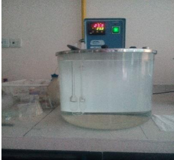
Resim 6.4. Sıcaklığı sabit tutacak su banyosu
