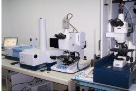
Resim 5.1. Fourier dönüşümlü kızıl ötesi spektrometresi
