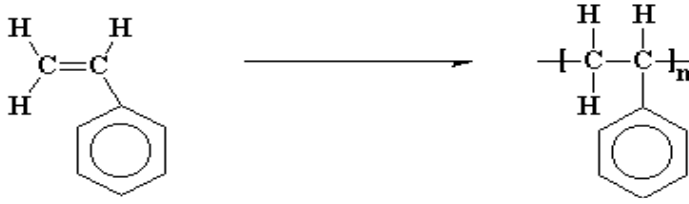
Şekil 3.5. Stiren molekülü polimerizasyon sonucu polistiren polimerine dönüşür
