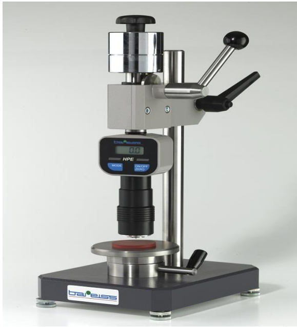
Resim 5.6. Shore D sertlik ölçme cihazı
