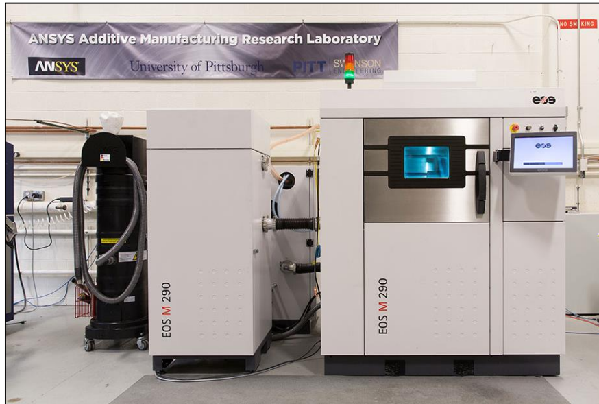
Şekil 3.5. M718 ve P718 alaşımların üretildiği EOS M290 SLE sistemi (ANSYS laboratuvarı, Pittsburgh Üniversitesi, ABD)
