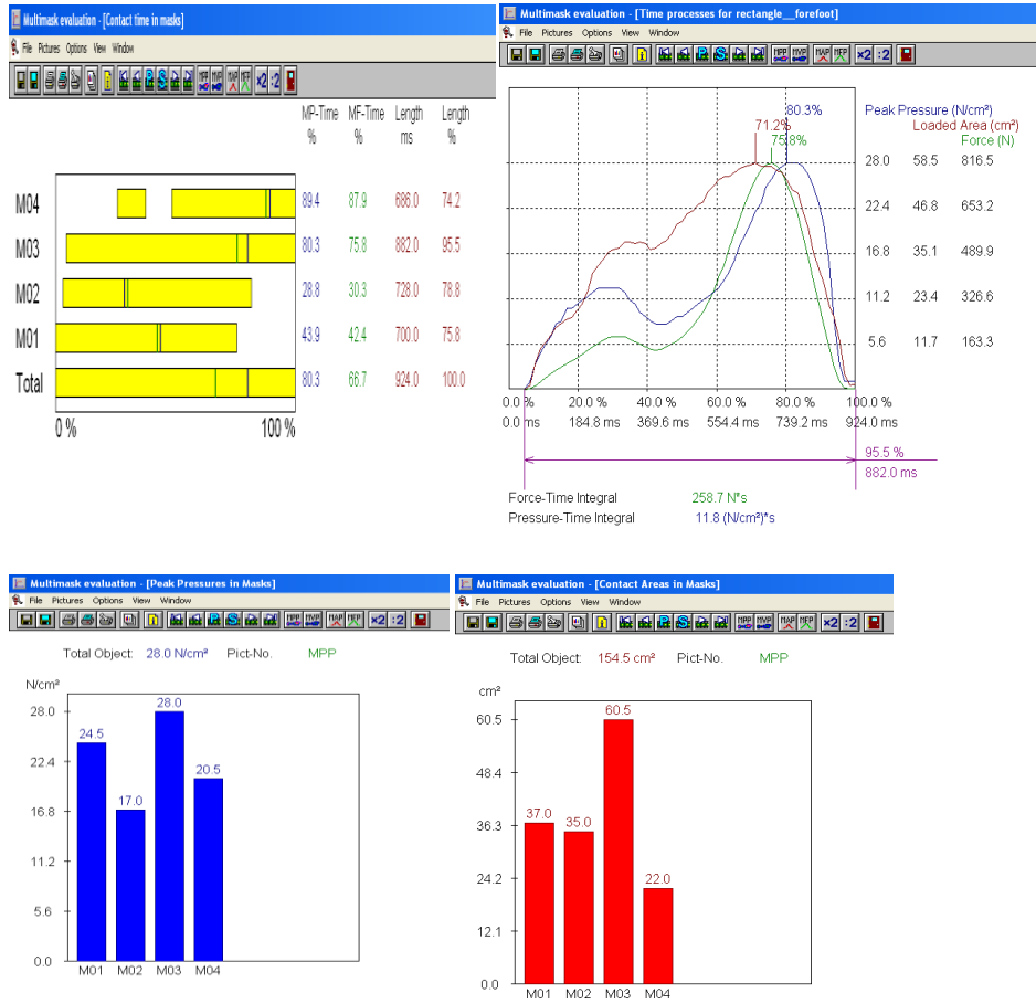
Şekil 25: Bölünmüş mask lara göre; temas alanı (cm²), maksimum kuvvet ( N), zirve basınç (N/ cm²), maksimum ortalama basınç (N/ cm²), basınç-zaman integrali [(N/cm²)*s] değişimi
