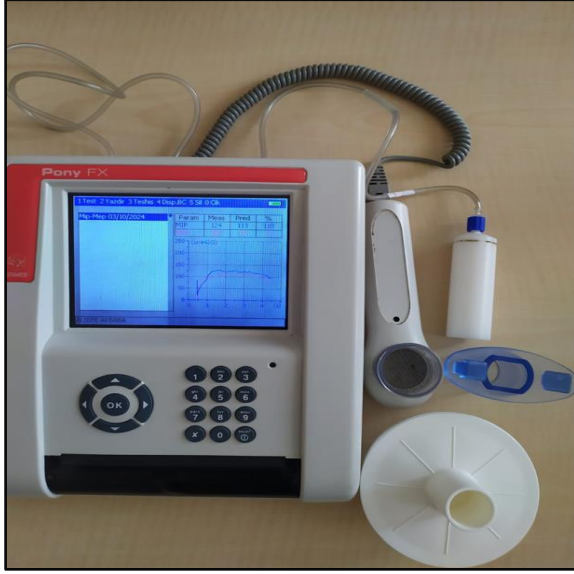
Resim 3.3. Pony FX solunum fonksiyon testi ölçüm cihazı
