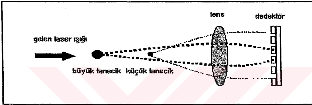
Şekil 3.2. Işık saçılmasının tanecik boyutu ile değişiminin şematik gösterilişi.
