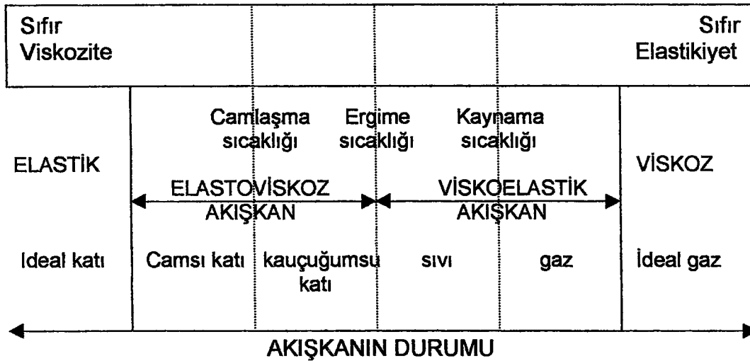
Şekil 3.3. Polimerler için akışkanın genelleştirilmiş durumu.
