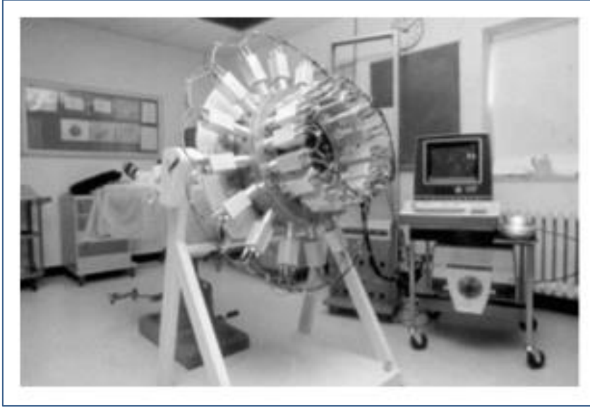
Resim 2.3. PMT dedektör dizini içeren ilk bilgisayarlı kafa tomografi cihazı [42]
