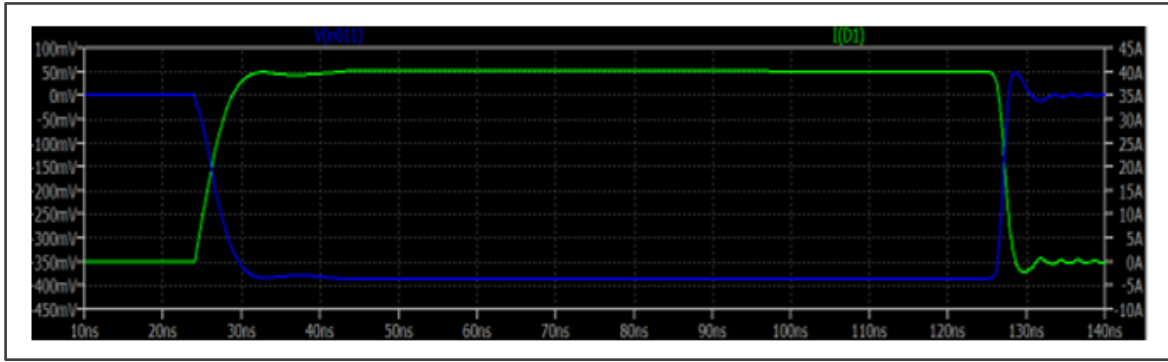
Şekil 3.14. Lazer diyot darbe akımı ve akım örnekleme voltajı
