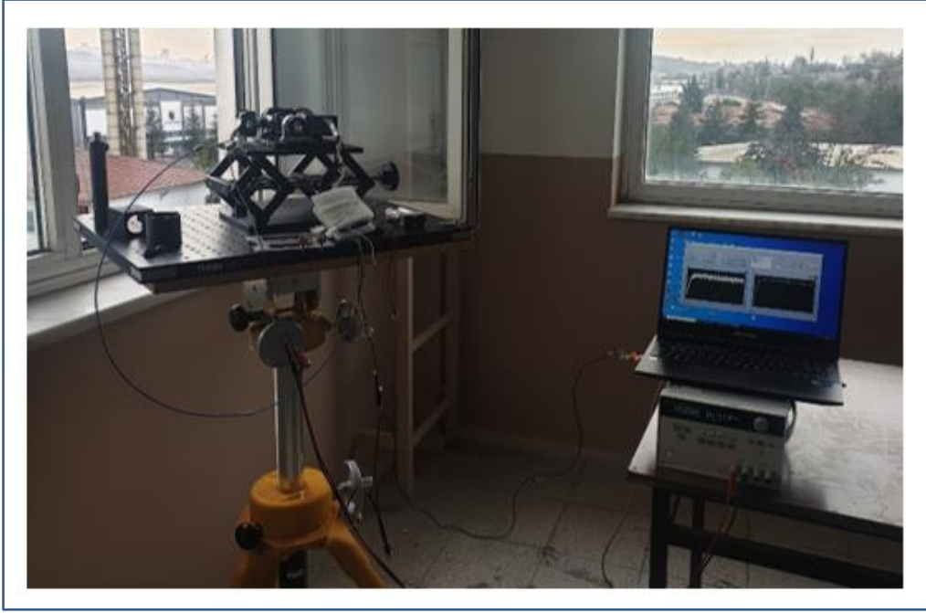
Resim 6.6. SoC MYiR MYC-C7Z010/20 tabanlı test düzeneği
