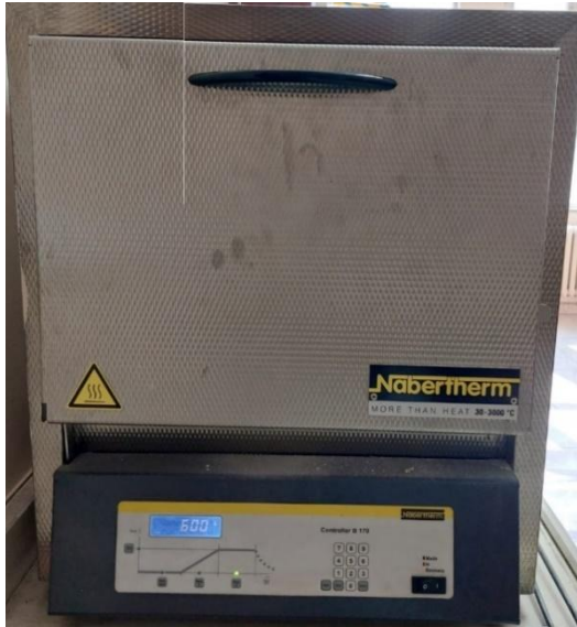
Resim 3.2. Laboratuvarında kullandığımız kül fırını
