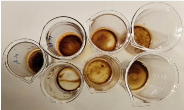
Resim 3.4. Su banyosu üzerinde kurutulan örnekler
