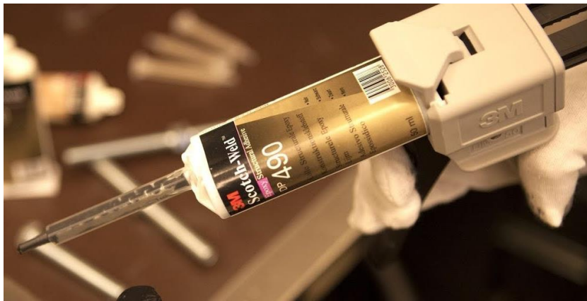
Resim 4.1. DP490 yapıştırıcısının tabanca ile uygulanması
