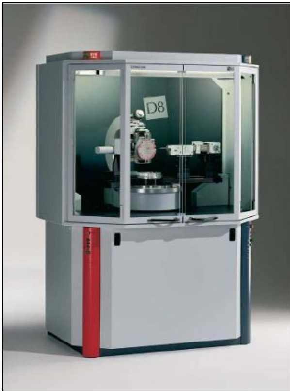
Resim 3.1. HR-XRD ölçümlerinde kullandığımız Bruker-AXS D8 Discover XRD cihazının görünüşü
