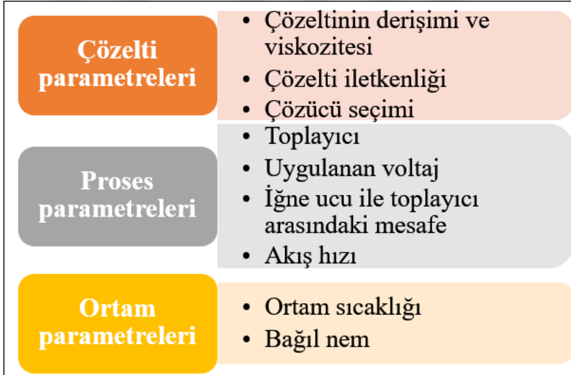
Şekil 2.5. Elektro-eğirme işlemini etkileyen parametreleri (Haider, A., Haider, S. ve Kang, 2018; Jain ve diğerleri, 2020)
