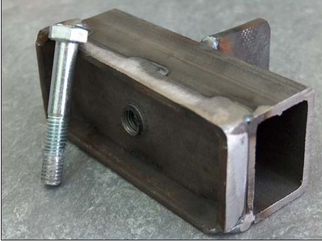
Resim 3.19. Çekme testi sonrası numune ve cıvata [1]
