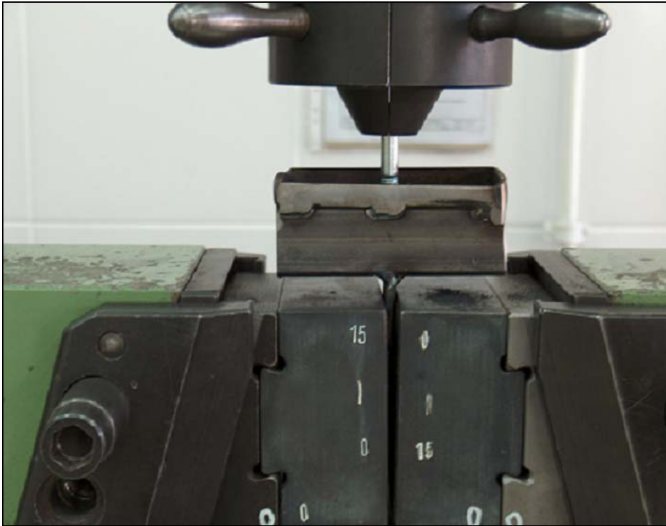
Resim 3.18. 2. tip test numunesinin çekme test cihazına bağlanması [1]
