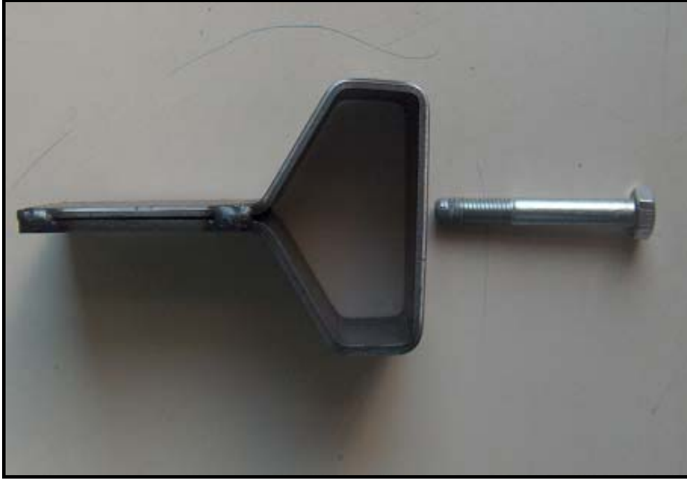
Resim 3.12. Sıyırma testi için hazırlanan örnek numune ve M8, 8.8 civata [1]
