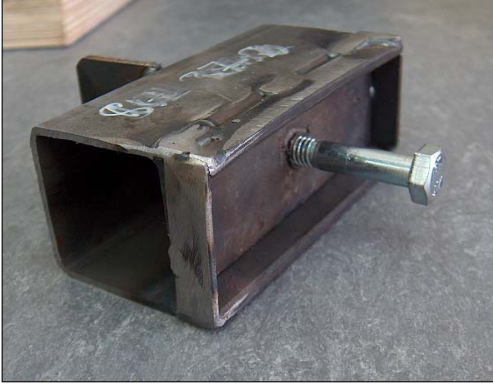
Resim 3.17. Özel tasarlanmış 2. tip test numunesi [1]
