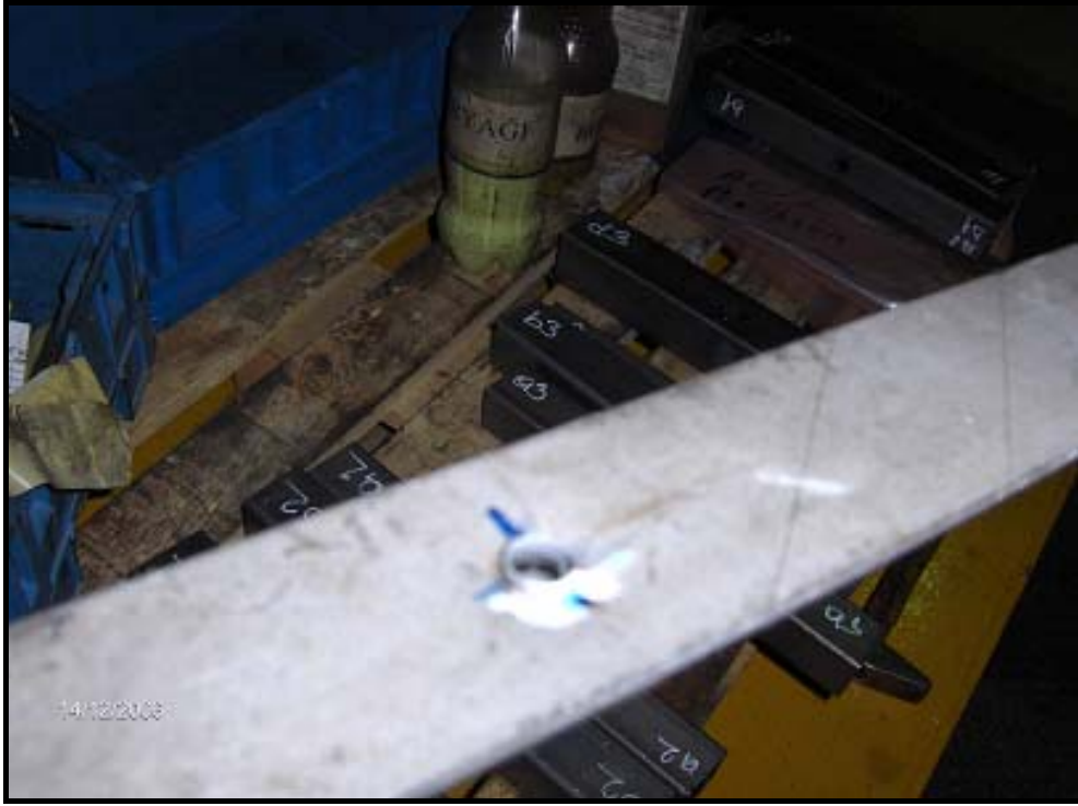
Resim 3.6. Sıvama işleminden sonra cıvata başı ile temas edecek yüzey [1]
