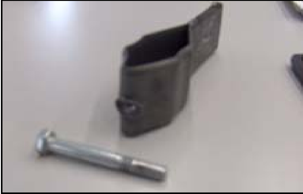
Resim 3.14. Civatanın malzemeden sıyrılmış hali [1]
