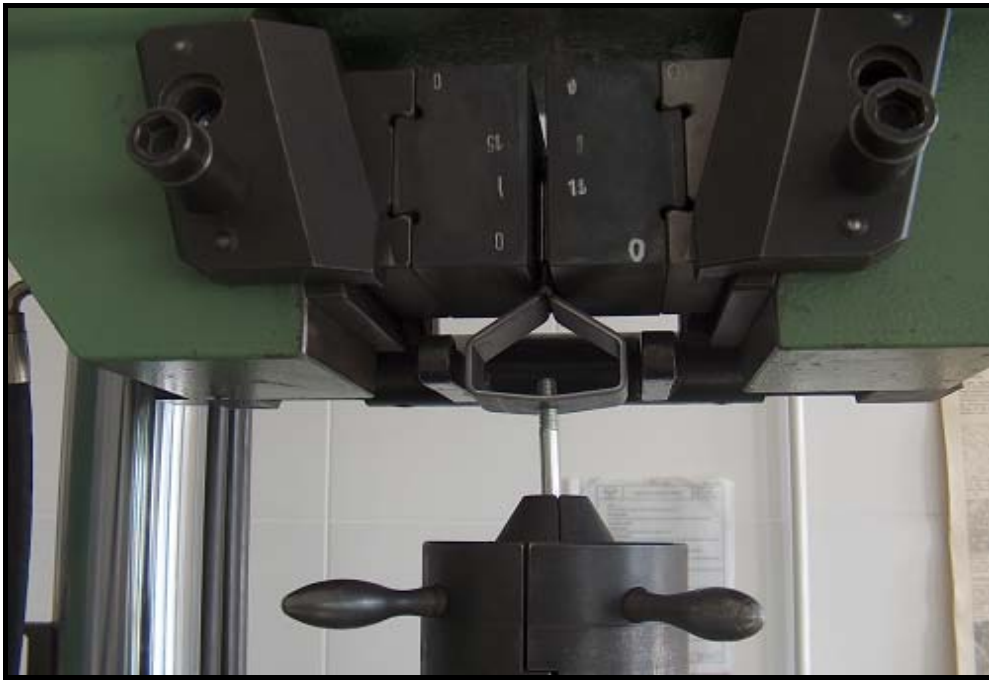
Resim 3.13. Özel tasarlanmış numunenin çekme testi [1]
