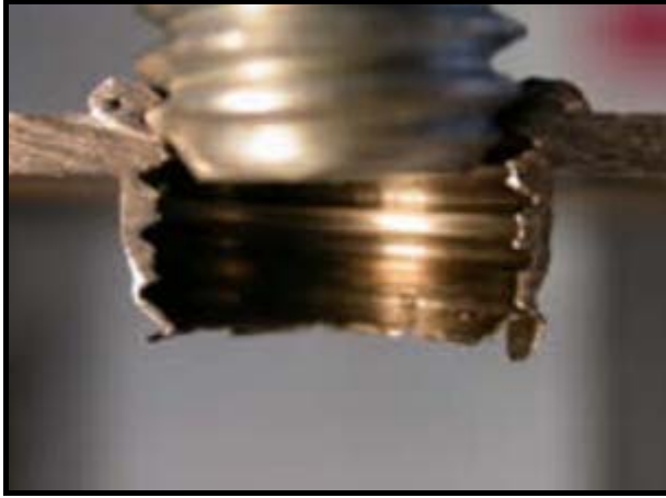
Resim 3.8. Sıvamadan sonra kılavuzla diş açılması [3]
