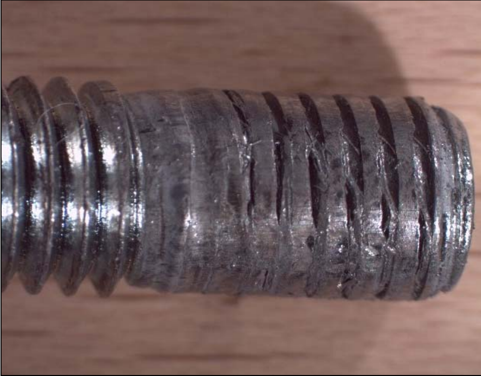
Resim 3.21. Çekme testi sonucu M8, 8.8 civatanın makro görüntüsü [1]
