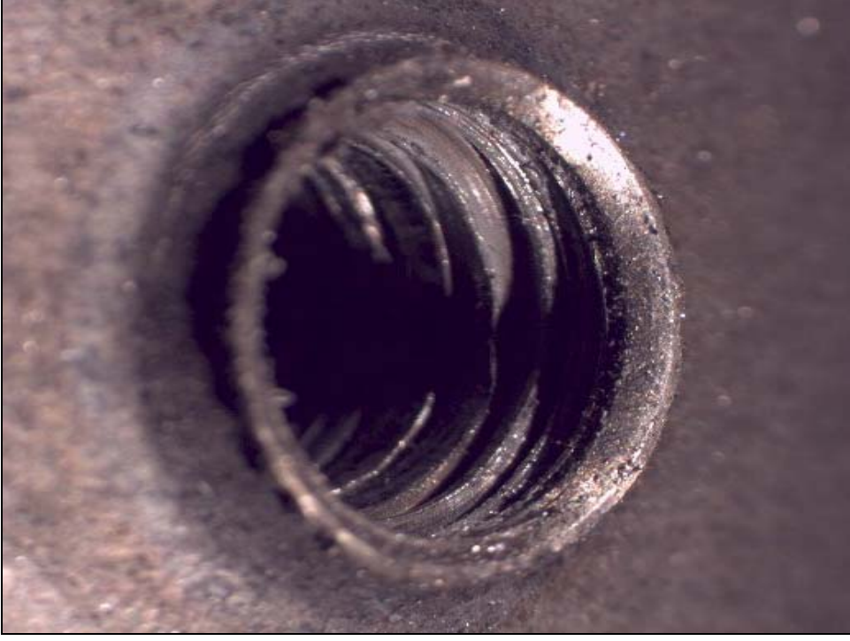
Resim 3.20. Çekme testi sonucu delik yüzeyinin makro görüntüsü [1]
