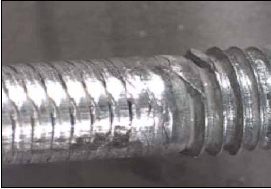
Resim 3.16. M8, 8.8 test civatasının sıyırılmadan sonraki makro yapısı [1]
