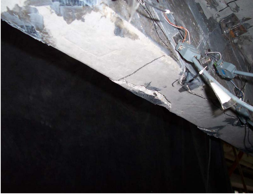
Resim 4.5. CFRP şeritlerin beton pas payını kaldırması
