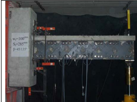
Resim 2.4. Kiriş-4 W_f=100 , S_f=285 , \beta=45/135^\circ
