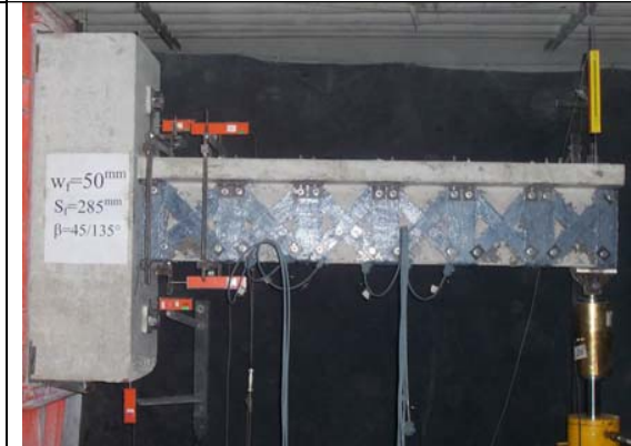
Resim 2.6. Kiriş-6 W_f=50 , S_f=285 , \beta=45/135^\circ
