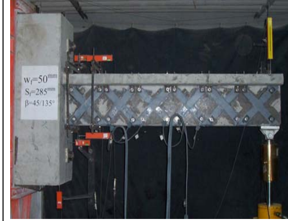
Resim 2.3. Kiriş-3 W_f=50 , S_f=285 , \beta=45/135^\circ
