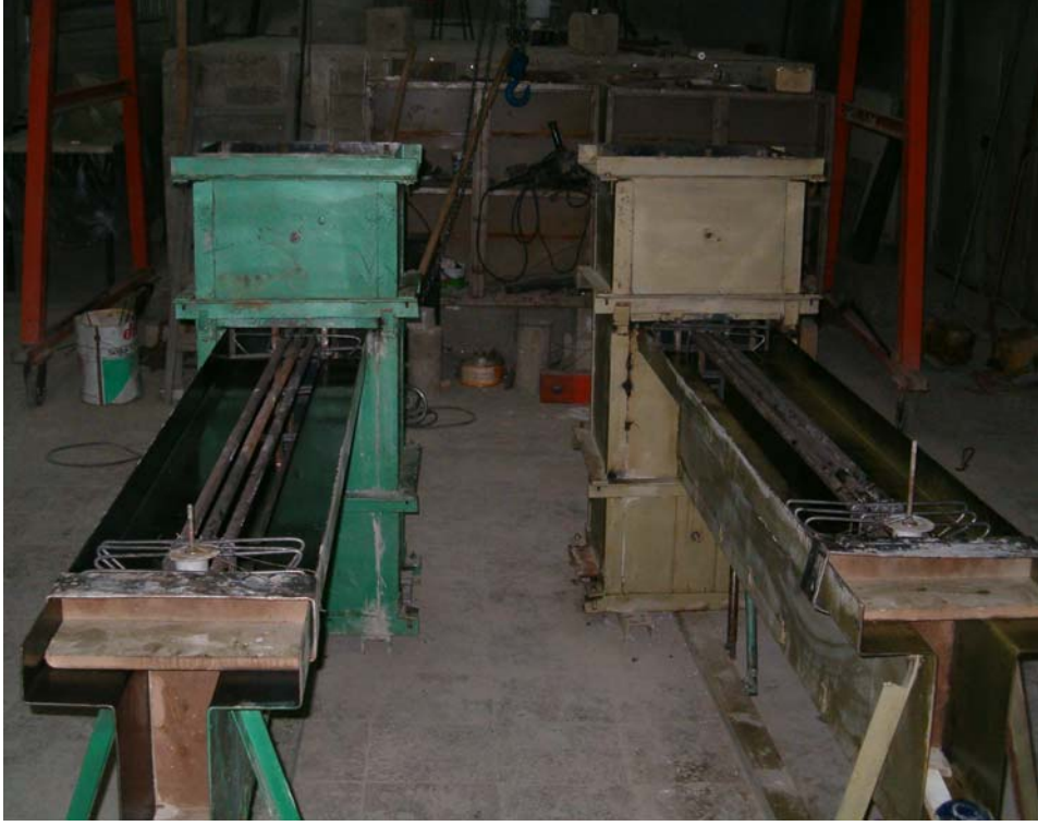
Resim 2.8. Beton dökümüne hazır deney elemanları
