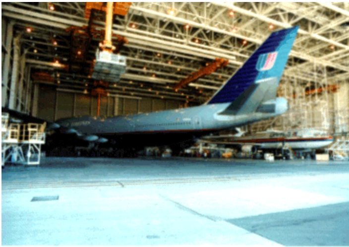
Resim 4.8.Çatıya yerleştirilmiş çalışma platformu
