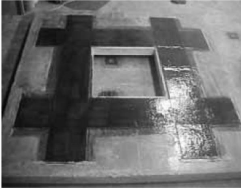
Resim 2.3. CFRP şeritlerin konumu (Casadei ve diğerleri, 2003)
