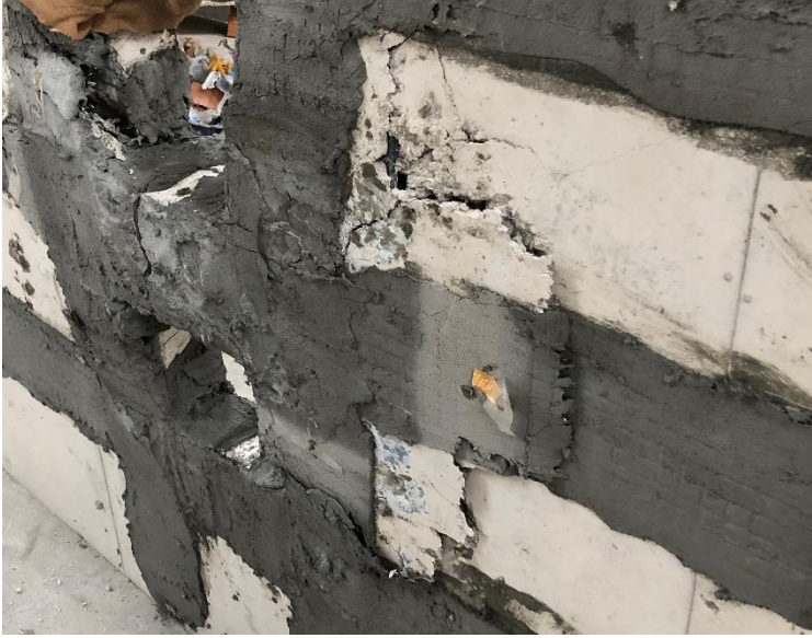
Resim 3.21. G-P-300 deney elemanında TGSK şeritte oluşan kopma
