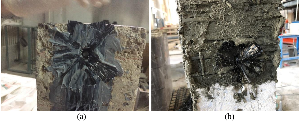
Resim 2.7. Ankraj detaylarında kullanılan yapıştırıcı malzemeler (a) epoksi ve (b) sıva
