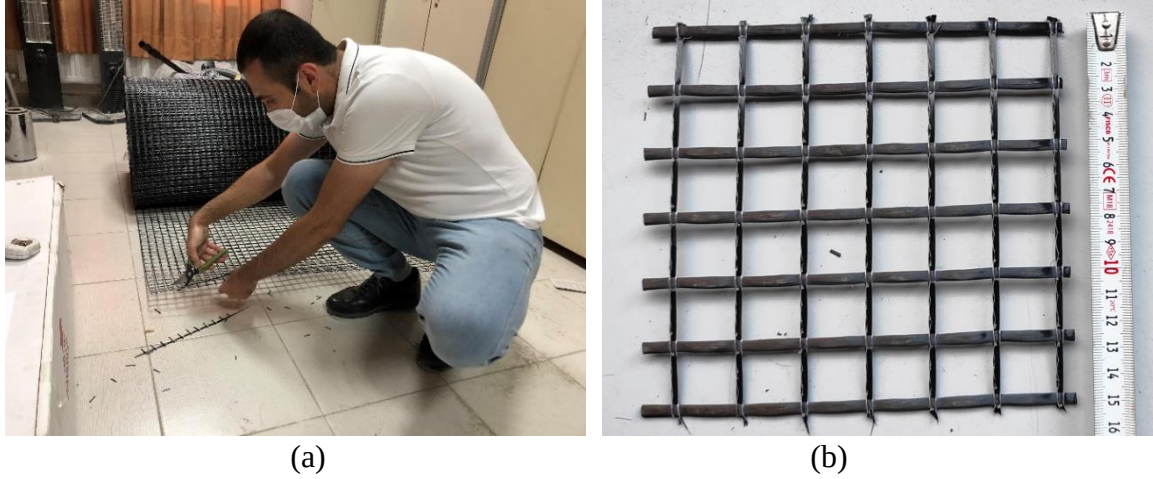
Resim 2.1. Karbon tekstilin (a) kesilmesi ve (b) geometrik özellikleri
