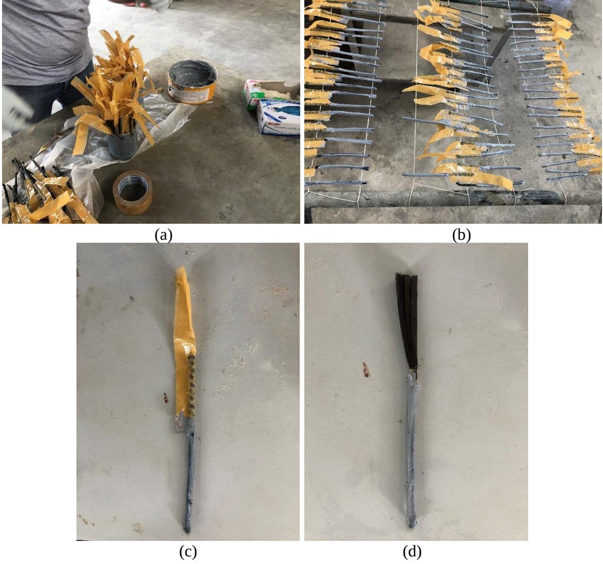
Resim 2.8. Ankrajların üretim aşamaları (a) kök kısmına epoksi emdirilmesi, (b) priz almasının beklenilmesi, (c) bantlı son hali ve (d) bant çıkarıldıktan sonraki hali
