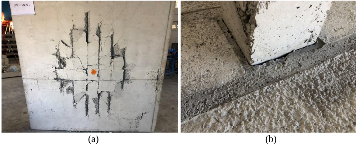
Resim 3.1. R0 deney elemanının (a) çekme ve (b) basınç bölgelerinin çatlak dağılımı
