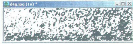
Şekil 6.15 [29-36] gri ton arası tresholding (Eşikleme) uygulanmış görüntünün ikili (Binary) forma dönüştürülmüş hali
