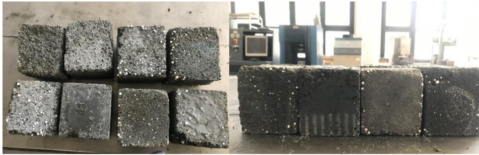
Resim 4.3. Donma-çözünme döngüsüne maruz bırakılan köpük beton numune örnekleri
