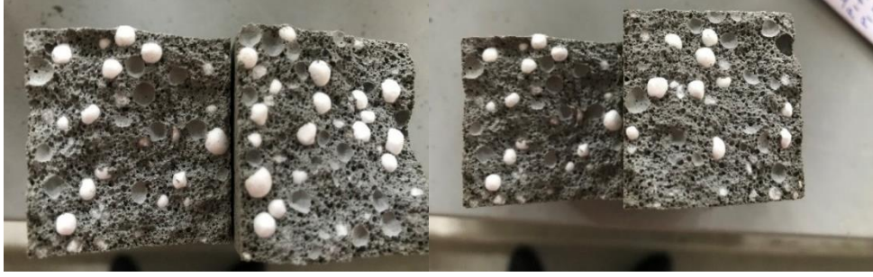
Resim 4.1. Eğilme testi sonucu kırılan numune örneği
