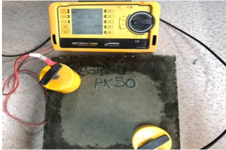
Resim 3.6. Elektriksel iletkenlik değerlerinin ölçülmesi
