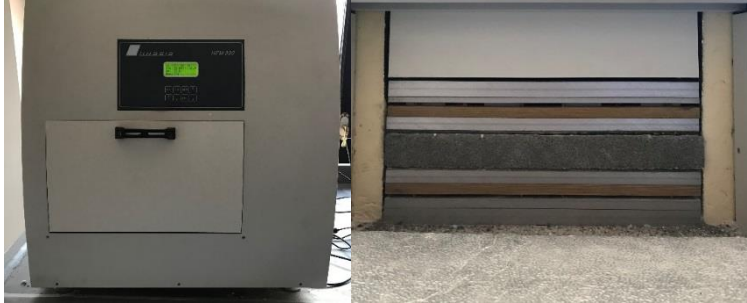
Resim 3.4. Isıl iletkenlik katsayısının belirlenmesinde kullanılan cihaz
