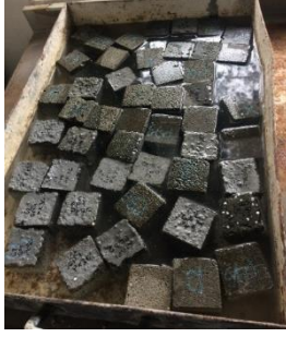
Resim 3.5. Asit çözeltisi içerisinde bekleyen köpük beton numuneleri
