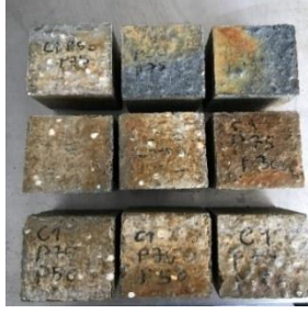
Resim 4.2. Asit çözeltisine maruz kalan köpük beton numunelerinin görünümü
