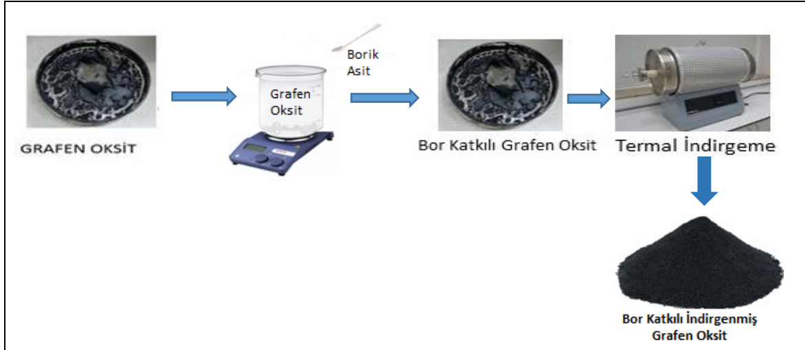
Şekil 3.2. Bor katkılı indirgenmiş grafen oksit sentezinin şematik gösterimi
