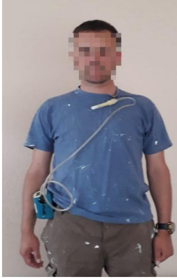
Resim 3.2. Toz ölçüm cihazının çalışana bağlanması
