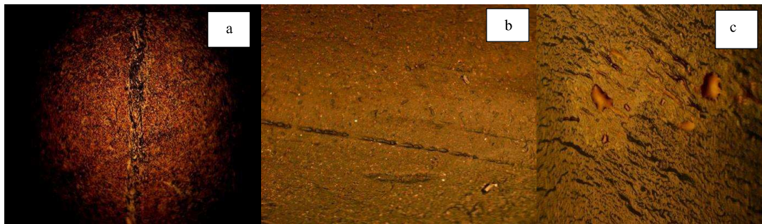
Resim 6.8. 6205-B180 2 kg yük asılı rulmanına ait a) bilya hatası b) dış bilezik hatası c) iç bilezik hatası (100x)
