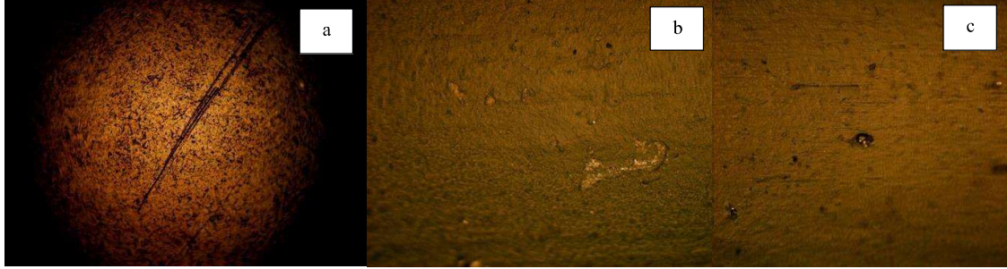
Resim 6.11. 86 dakika çalışan 6205-PA 1 kg yük asılı rulmanına ait a) bilya hatası b) dış bilezik hatası c) iç bilezik hatası (100x)
