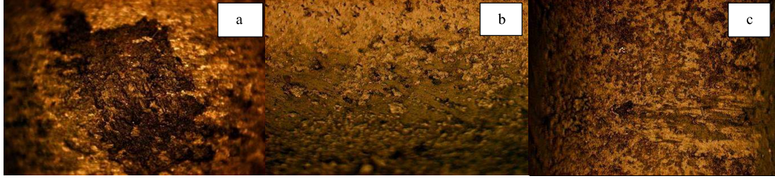
Resim 6.6. 6205-PA 2 kg yük asılı rulmanına ait a) bilya hatası b) dış bilezik hatası c) iç bilezik hatası (100x)
