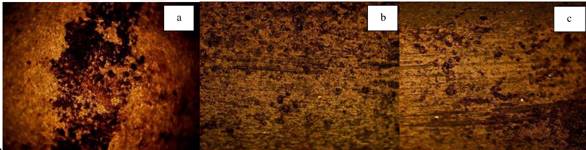
Resim 6.2. 6205-B180 1 kg yük asılı rulmanına ait a) bilya hatası b) dış bilezik hatası c) iç bilezik hatası (100x)
