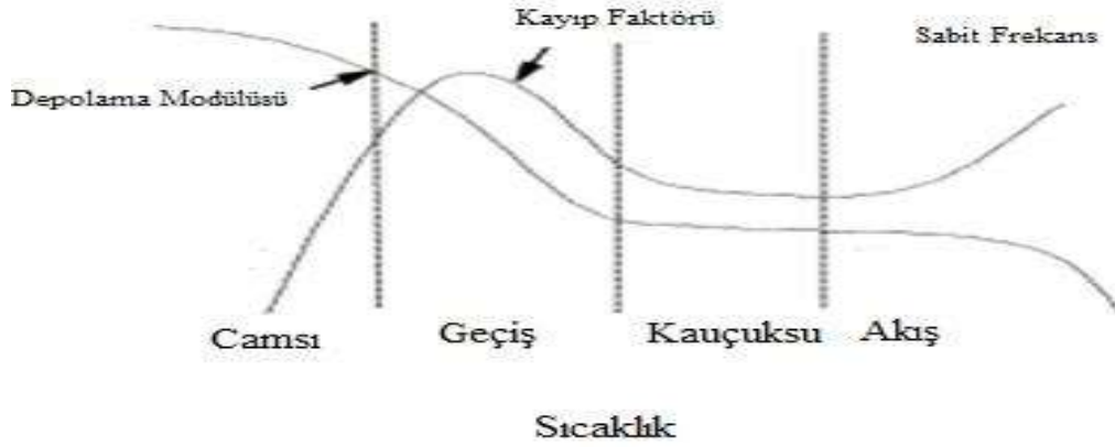
Şekil 3.12. Viskoelastik malzemelerin sıcaklıkla değişen sönüm oranı grafiği [88]
