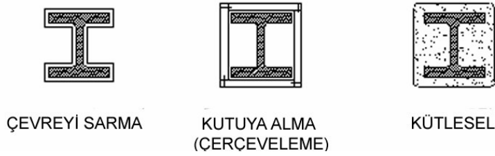
Şekil 3.2. Çelik yapı bileşenlerinde uygulanan yalıtım türleri [52, 55]
