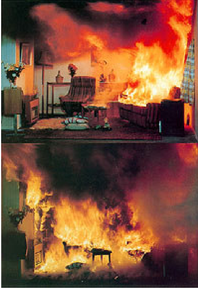
Resim 2.1. Kapalı mekandaki yangının büyüme (flashover) aşaması [25]
