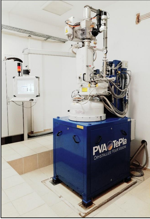
Resim 7.1. Cz hacimli tek-kristal büyütme sistemi (Gazi Fotonik)
