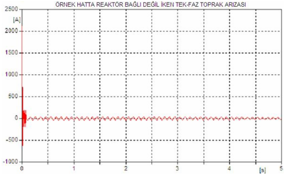
Şekil 6.2.a. Senaryo 1 için sekonder ark akımı
