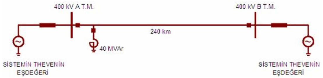
Şekil 6.1. 400 kV örnek iletim hattının tek hat şeması
