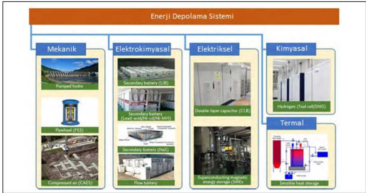
Şekil 2.1. Kimyasal yapılarına göre enerji depolama teknoloji sınıfları [7]
