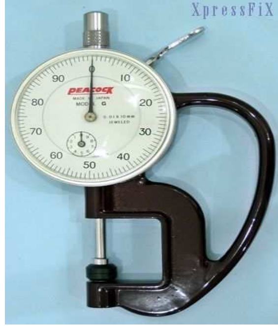
Resim 4. Deneylerde kullanılan kompas (Peacock, 0.01mm, Ozaki Co., Japonya).
