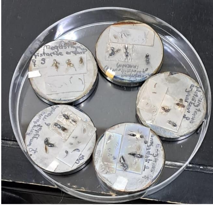
Resim 2.4. SEM için stab üzerine örneklerin konulması
