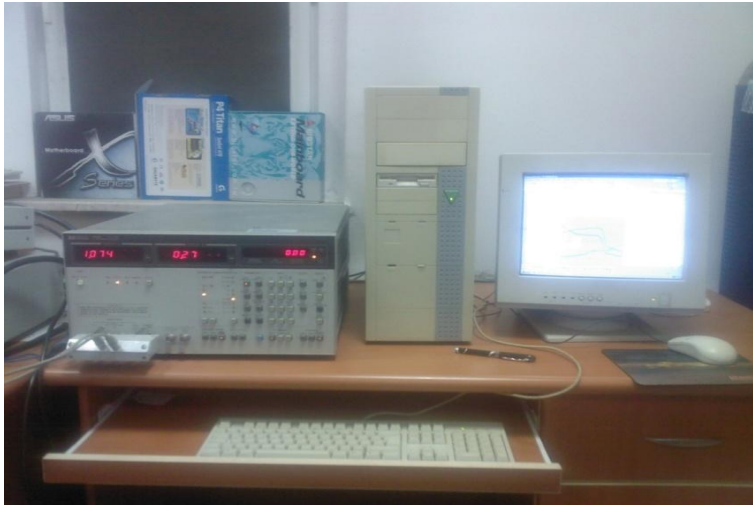
Resim 3. 1. Kapasitans-voltaj ve iletkenlik-voltaj ölçümleri için kullanılan düzenek Hawlett Packard 4192 LF Empedaes Analiz metre
