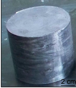
Resim 5.2. Preslenmiş ham yoğunlukta TM blok numune.
