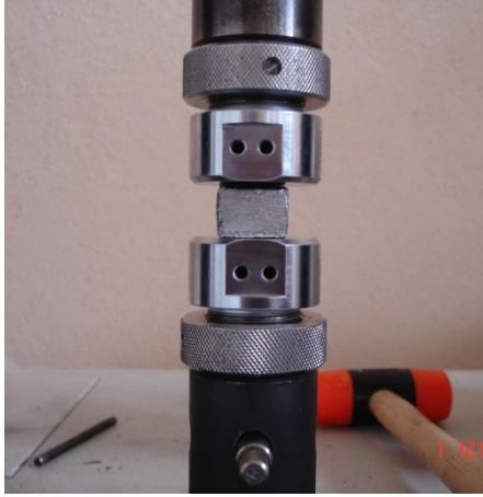
Resim 5. 5. Basma testleri için hazırlanan düzenek.
