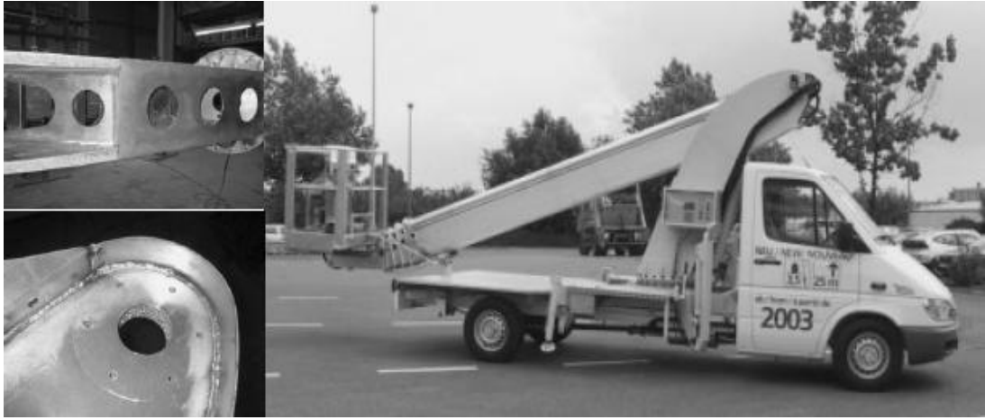
Resim 4. 10. ASK'lerin araçların taşıyıcı kollarında kullanımı [66].
