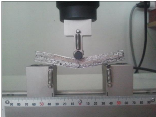
Resim 5. 6. Üç nokta eğme deneyi.
