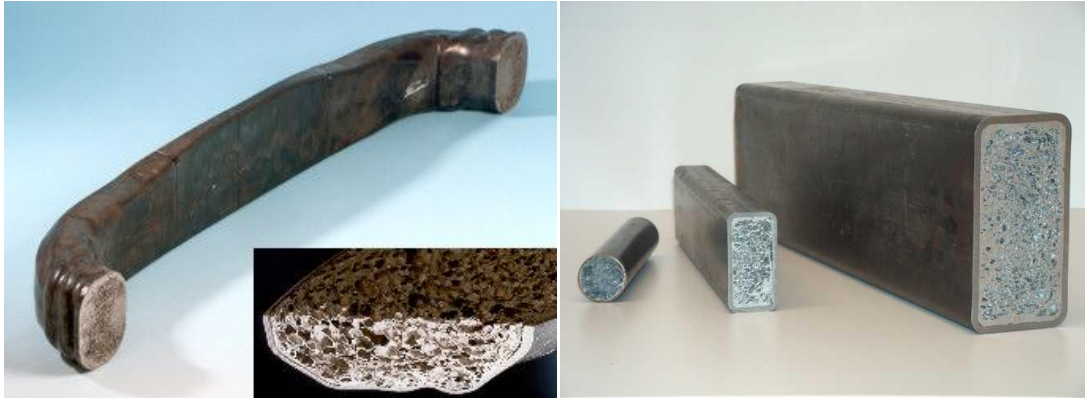
Resim 3.3. Profil içerisinde köpürtülmüş metalik köpükler [3].
