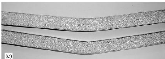
Resim 4. 8. Farklı yükseklikte Al köpüğe sahip ASK'lerin eğme dayanımı deformasyonu [61]
