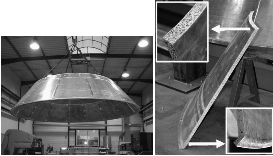
Resim 4.11 Ariane 65 isimli rokette kullanılan bir adaptörün genel görüntüsü ve belirli bölgelerin kesit görüntüleri [67]
